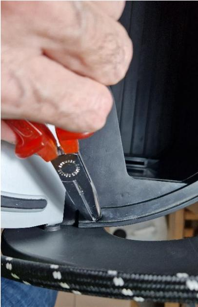
5. Wassertank herausnehmen. Die vier Verrastungen in der Wassertank Aufnahme lösen. Dazu die Laschen leicht nach innen drücken. Gegebenenfalls dabei mit den Fingernägeln der zweiten Hand in die Schattennut hineinhaken und die Abdeckung leicht nach vorne ziehen. Bitte mit Gefühl arbeiten, sonst reißen die Rasthakenösen ab (wie bei den unteren beiden im Bild). Hinweis: Im Bild unten ist die weiße Abdeckung bereits abgenommen, als das Bild entstand.
