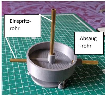
In der dargestellten Realisierung ist die Auffangschale nach unten federnd gelagert. Dies kann auch weggelassen werden. Die Federn drücken das Einspritzrohr gegen die Verkalkung im Wasserauslass. Man kann sehen, wie die Auffangschale über die Zeit des Entkalkungsvorgangs kontinuierlich weiter nach oben wandert, während sich die Ablagerungen im Rohr auflösen.
