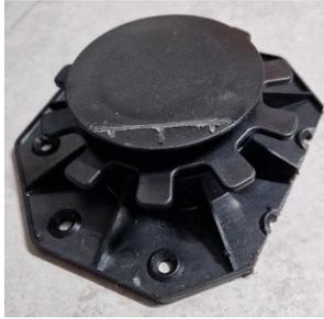
Rohraufnahme der Auffangschale und bei Verwendung des gefederten Untersatzes sollte das gerade so möglich sein. Unter die Auffangschale habe ich das Stelzlager geschoben und die Höhe vorher so eingestellt, dass die Federn gut gespannt sind, so dass die Auffangschale im Laufe der Entkalkung kontinuierlich nach oben gedrückt wird, bis der Rand der Schale schließlich gegen die Decke der Auffangschalenöffnung stößt (nach ca. 30 Minuten Entkalkung). Wegen begrenzter Tiefe der
