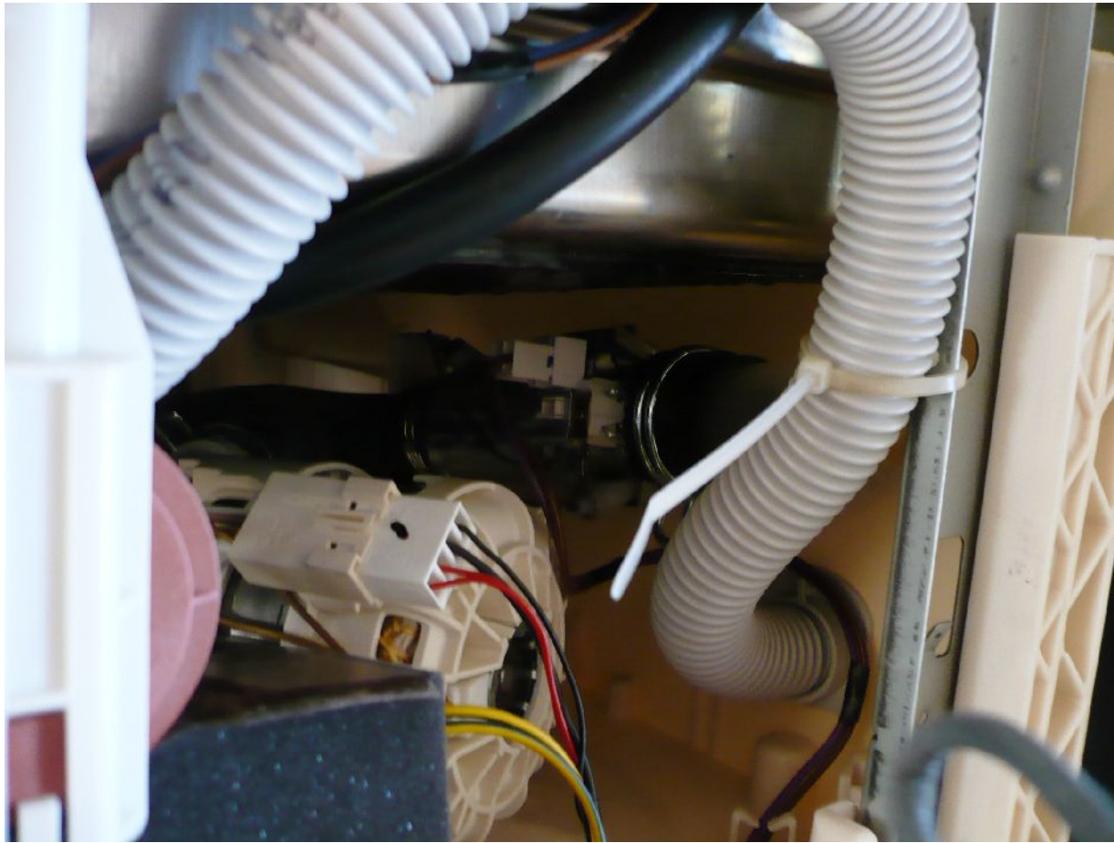
Anschlüsse Heizung: 2 Kabel (Widerstand stromlos, „nicht angeschlossen“ gemessen) 26 Ohm
